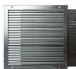
Sl. 41. Prezračevalna rešetka, protipožarna, 300x300 [mm] – prezračevalna površina 0,036 [m 2 ]
