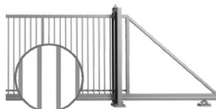
Polnilo zaprtega škatlastega profila 30x18mm, privarjeno na konstrukcijo.
