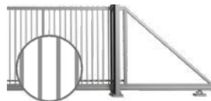
Polnilo zaprtega škatlastega profila 30x18mm, privarjeno na konstrukcijo.
