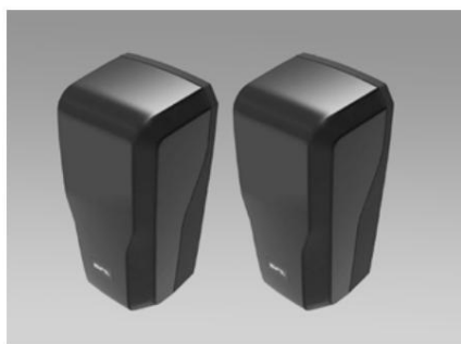
FOTOCELICE – nameščene na stebrih vrat – ko se v odprtini pojavi predmet, se infrardeči žarek prekine in gibanje se ustavi.
