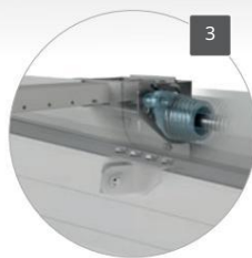
3 Vgrajena varnostna naprava pred zlomom vzmeti V malo verjetnem primeru zloma vzmeti se vratno krilo ne spusti.
