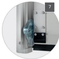
7 Varnostna zavora Varnostna zavora preprečuje padeč krila v primeru poškodbe kabla.
