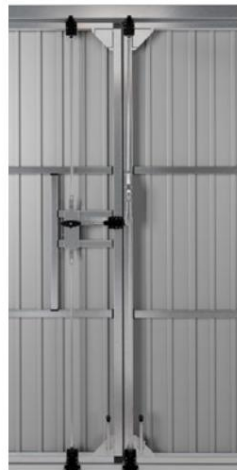
Aktivno krilo, zaskočeno v treh točkah, ko je H > 2700 [mm] – gledano od zunaj.
